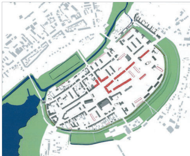
Plan Abriss und geschossweiser Rückbau von Gebäuden
